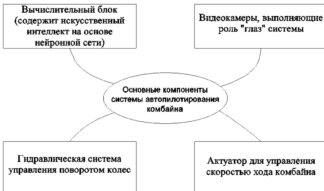
Рисунок 1 – Основные компоненты системы автопилотирования комбайна
